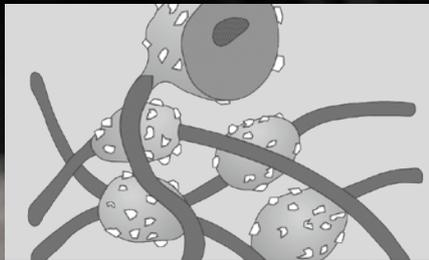
**Verbindung von synthetischen Fasern und Schleifkörnern**
