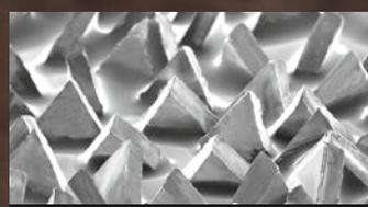
3M Präzisionsgeformtes Korn
